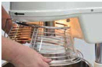
3 Protection amovible et rotative avec visière adaptable
